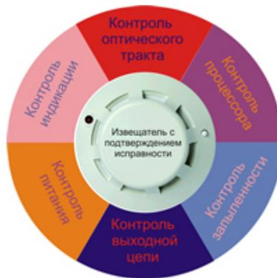
Рис. 1. Система самотестирования пожарного извещателя: основные узлы подлежащие контролю исправности. Здесь же показана наиболее важная для практики сервисная функция - контроль запыленности оптического тракта.
