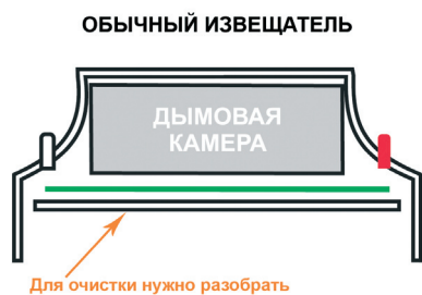
Рис. 2. Устройство обычного извещателя
