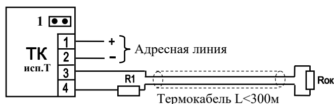
Рис.6. Схема подключения к МАКС-ТК исп.Т линейного извещателя (термокабель). При установленном джампере 1 при срабатывании извещателя адресная метка формирует сигнал «Внимание», при снятом джампере – сигнал «Пожар». Номиналы резисторов (0,25 Вт, \pm 5\% ): R_{ок} = 2,2 \text{ кОм} ; R_1 = 560 \text{ Ом} .
