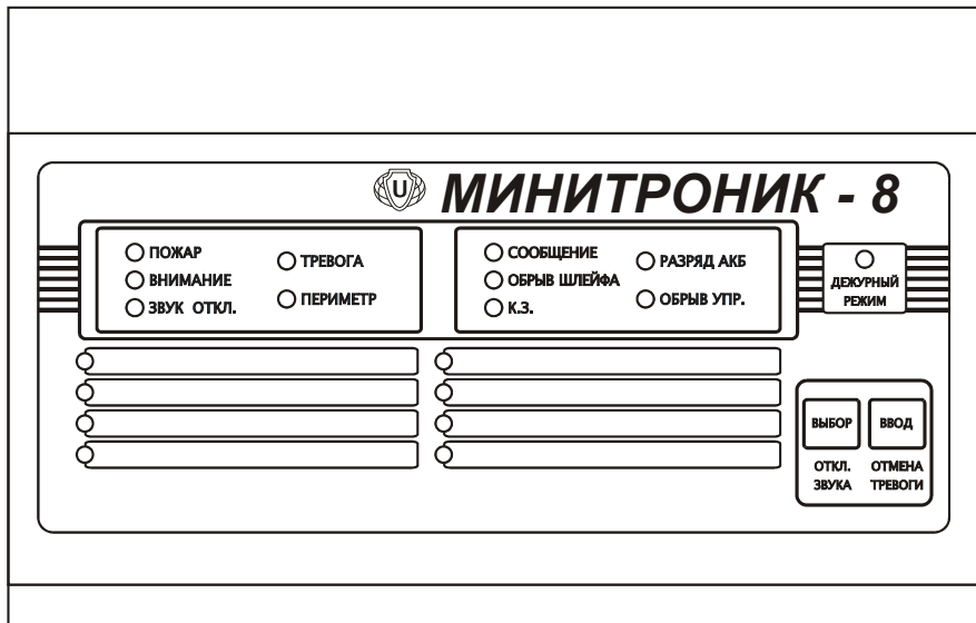
Рис.1. Внешний вид приемно-контрольного охранно-пожарного прибора "Минитроник 8".
