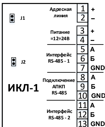
Рис.2. Назначение клемм изолятора.
