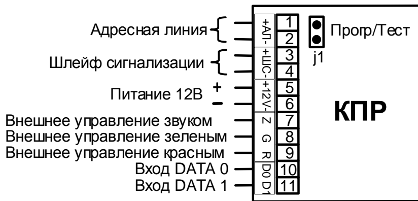
Рис. 2. Назначение клемм КПП.
