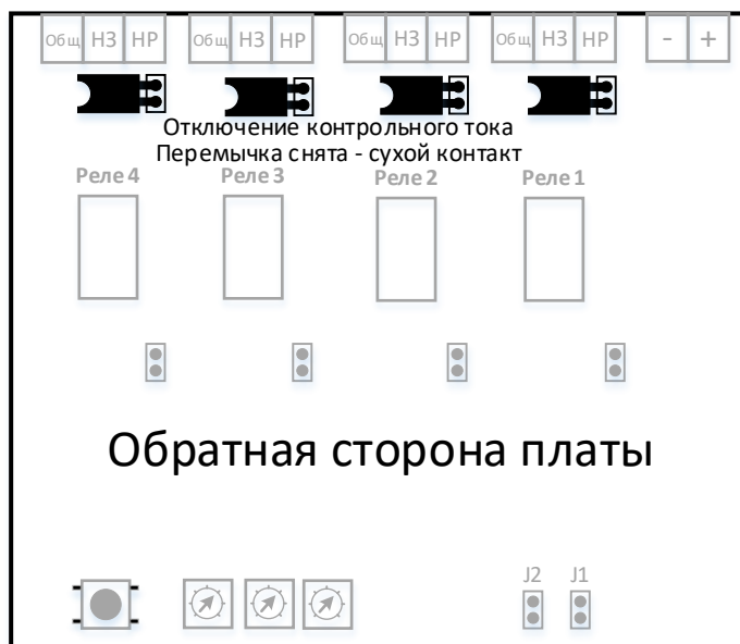
Рис.3. Расположение джамперов отключения контрольных цепей от клемм реле.
